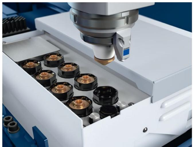
Le changement de buse de coupe à la main, c'est du passé : avec le changeur de buses automatique, votre machine expédie cette opération en une fraction de seconde.
