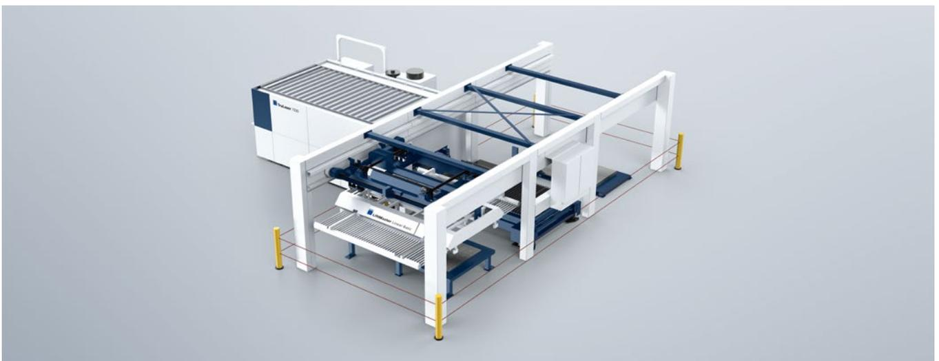
Le LiftMaster Linear Basic charge et décharge votre machine de manière entièrement automatique.
