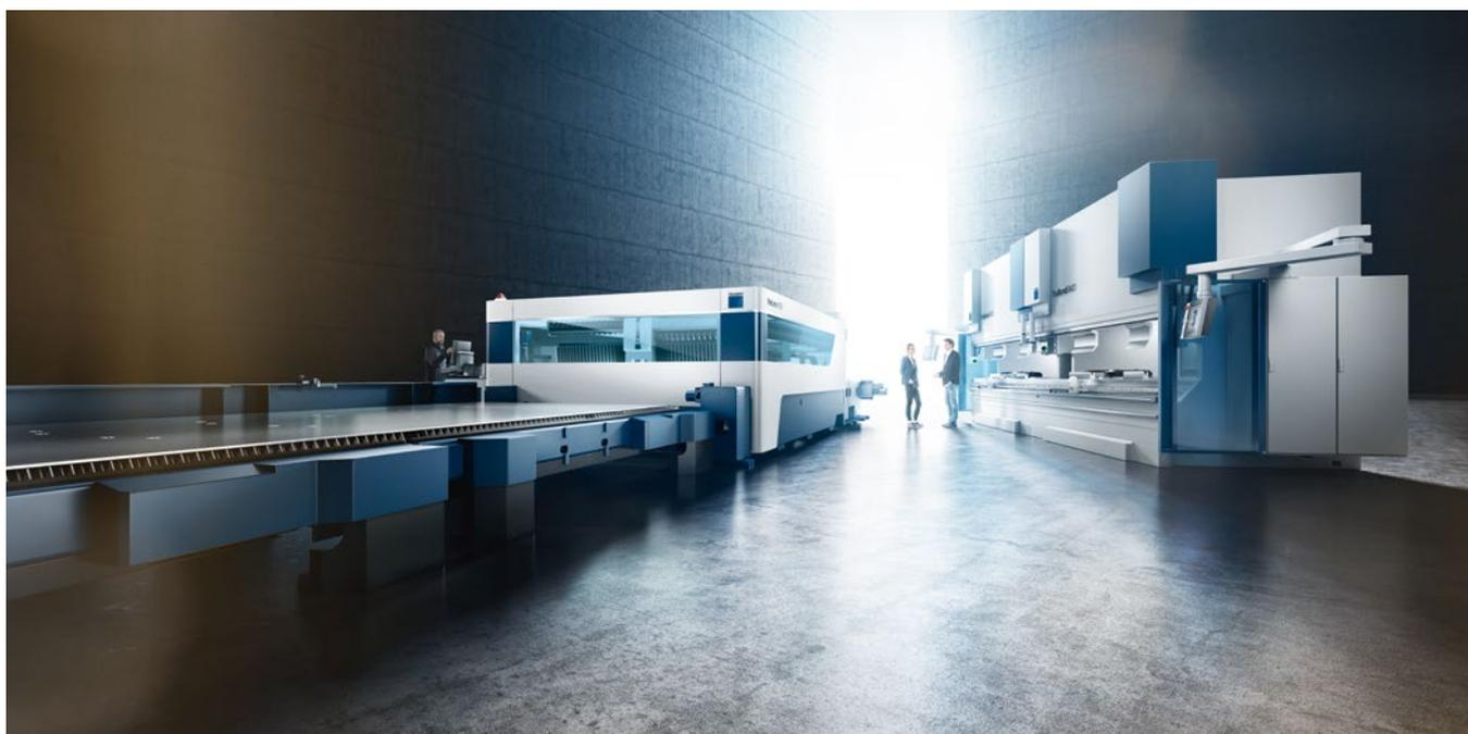
TruLaser 8000 et TruBend 8000 : découpe laser et pliage de pièces surdimensionnées.
