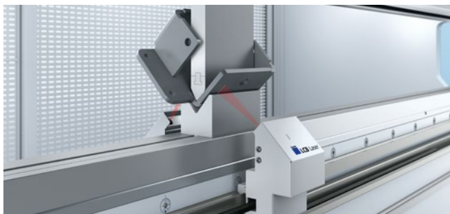
LCB (Laser Controlled Bending) : la variante de mesure d'angle contrôlée par laser de la TruBend Série 8000.
