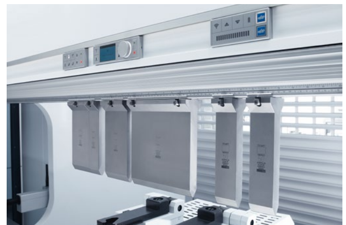
Lors de la préparation, le Tool Indicator indique exactement où les outils de pliage doivent être utilisés.
