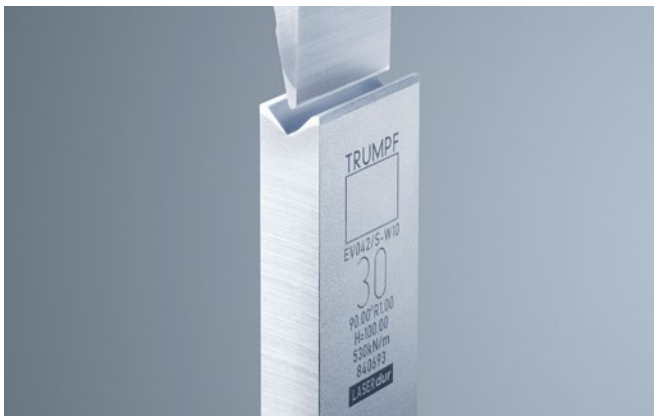
Conférer à vos outils une dureté de surface élevée et d'excellentes propriétés de glissement en les soumettant aux procédés de trempe LASERdur AL et LASERdur ZN.
