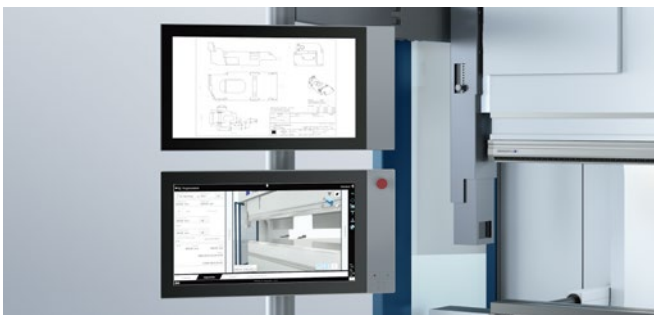
Un écran de contrôle supplémentaire fournit une meilleure vue d'ensemble.
