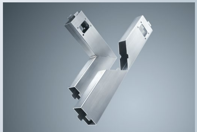
Liaisons par pliage et aides au positionnement réalisées avec efficacité, au laser.
